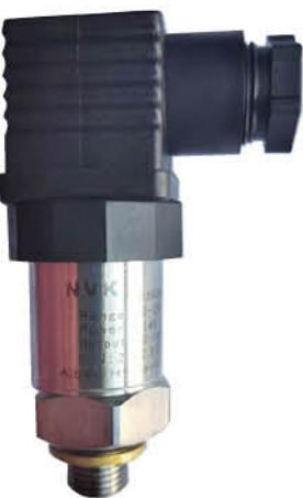
美国NVK压力传感器是基于放置在不锈钢膜片上的薄膜敏感元件技术，采用最新瑞士Metallux芯片和紧凑不锈钢构造，使传感器非常坚固和可靠，适用于高压冲击、震动、高低温的恶劣液体条件下，如注塑机、压铸机、油压机等。
