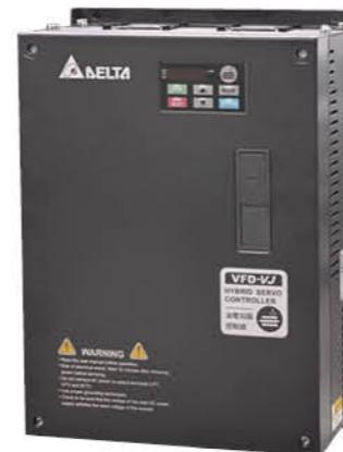
VFD-VJ系列是台达致力于橡塑行业应用多年的油电伺服驱动器，具有2.2倍优异的过载性能、深度弱磁控制、电机启动速度快、输出一致性好、多重保护等特色，支持SPM和IPM电机算法，提供风冷和液冷两种机型，适用于各种工作环境。
