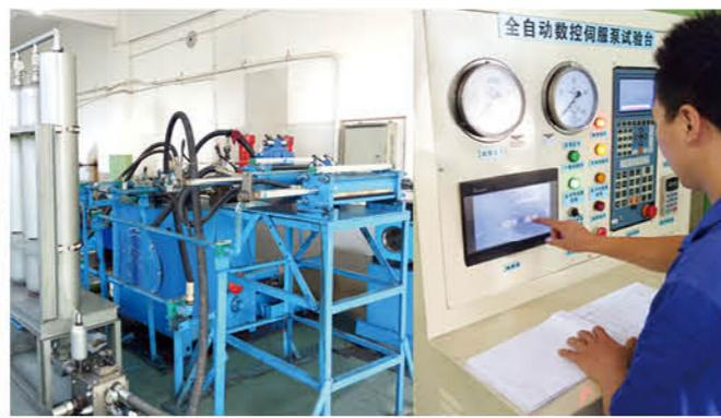
伺服泵全自动测试平台 / Servo pump automatic test bench
