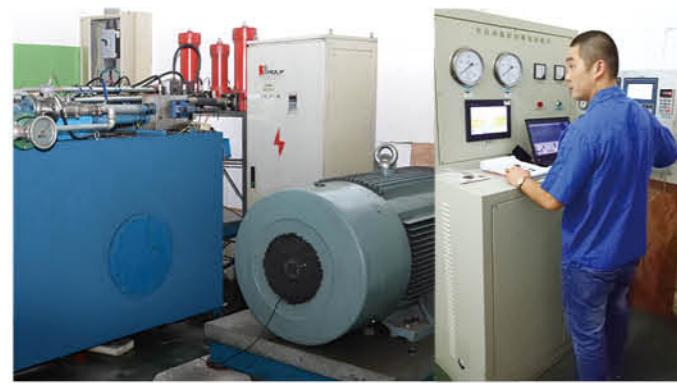
电机功率250KW 转速3000r/min 超大功率叶片泵全自动测试平台
